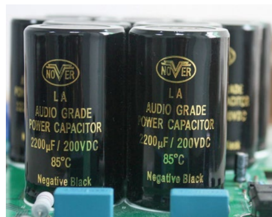
W zasilaczu zastosowano kondensatory elektrolityczne renomowanego angielskiego producenta, firmy NOVER.
